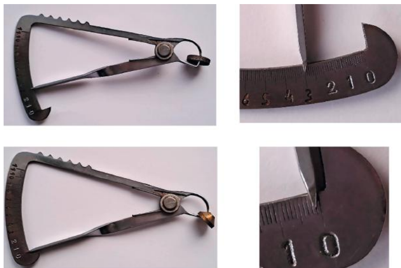
Рисунок 5 – Стоматологічний мікрометр з досліджуваними зразками.
