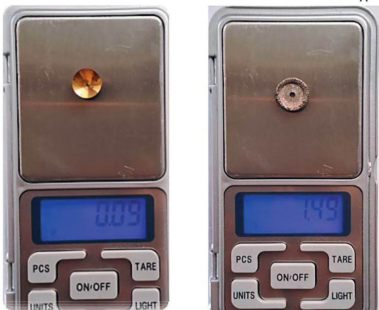
Рисунок 4 – Ваги ювелірні МН-200, від 0,01г. – 200г Pocket Scale.
