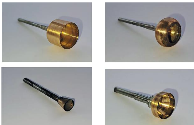
Рисунок 3 – Загальний вигляд та форми порожнистих тонкостінних головок.
