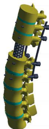
Рисунок 1 – Математична скінчено-елементна модель грудно-поперекового відділу хребта людини
