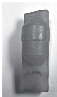
Рис. 5. Зразок після дослідження на відрив.
