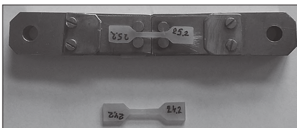
Рис. 2. Вигляд усталеного в пристосування зразка для експериментів на розтяг.
